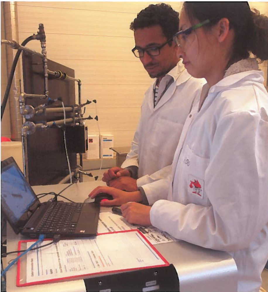
Proefopstelling 'sewer mining': van rioolwater schoon water maken via keramische membranen.
