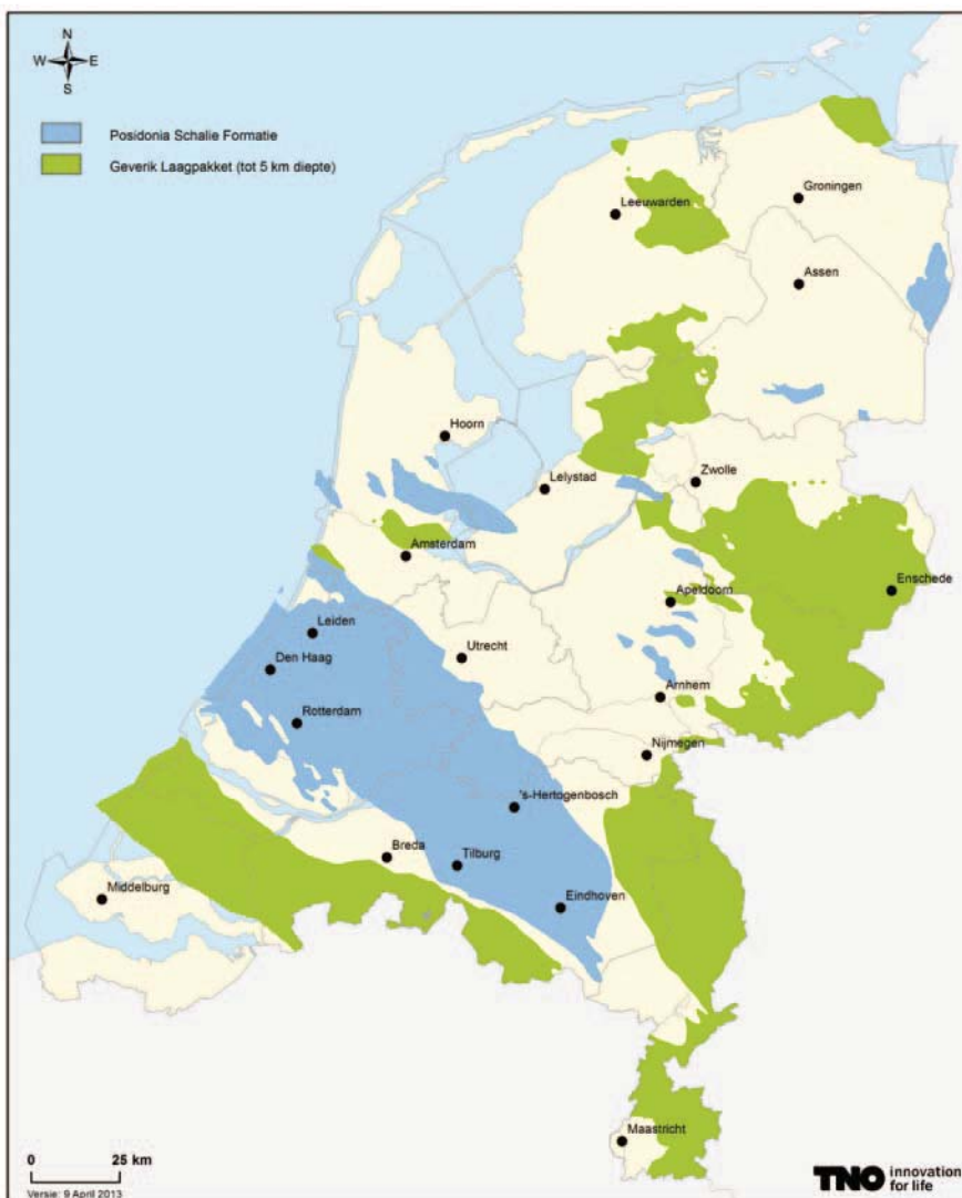
In Nederland zijn er naar alle waarschijnlijkheid twee soorten lagen waar schaliegas in opgesloten zit. Deze lagen zitten op verschillende dieptes en hebben verschillende ouderdom.
