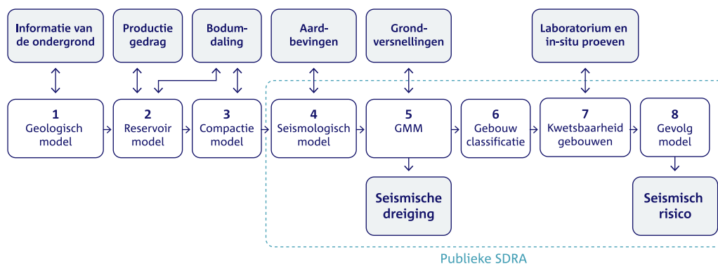
Figuur 9.2 Schematisch overzicht van de rekenmodellen die nodig zijn om de risico's van de gaswinning te berekenen in de seismische risicoanalyse
