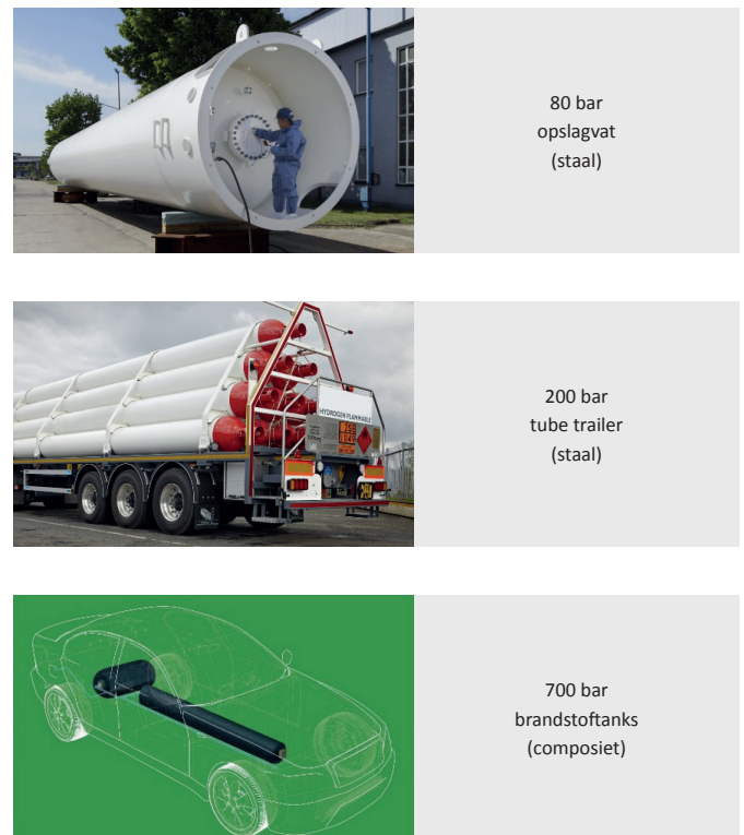
Figuur 33: Verschillende toepassingen en afmetingen van hogedruktanks voor waterstof
