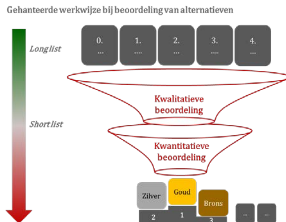
Figuur 8: door netbeheerders gehanteerde werkwijze voor het bepalen van de optimale netverzwaring.
